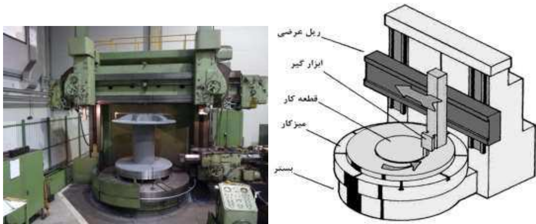
شکل ۳-۱ شمای کلی یک دستگاه تراش کاروسل
