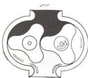
شکل 5- ساختمان پمپ گوشواره ای
